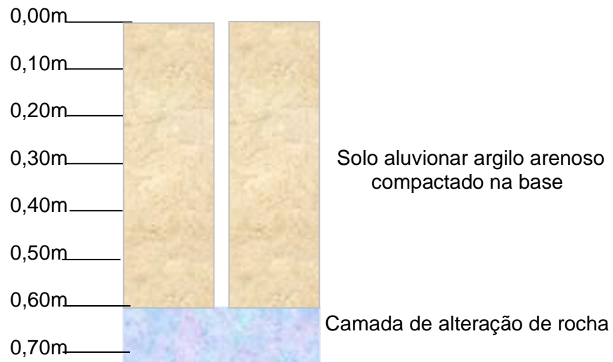
Fig. 02: Perfil esquemático em S 02, no eixo com profundidade de 0,60m.
