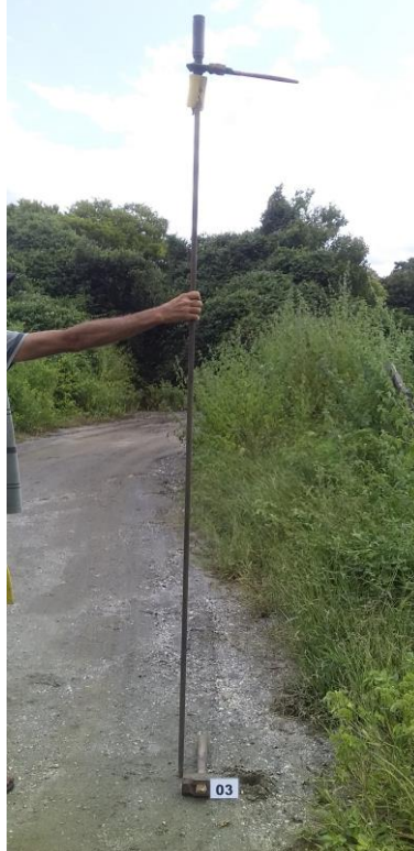
Fotos 04 e 05 – Sondagem em S 03 com Profundidade de 2,25m.
